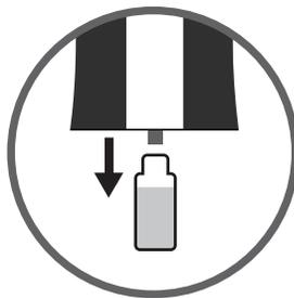
2. Reservoir öffnen, Patrone nach unten ziehen und entfernen.
