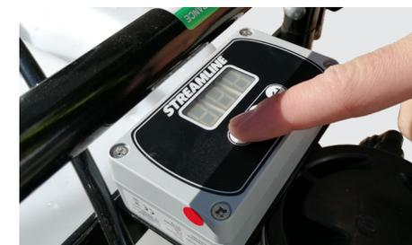
Überprüfen Sie die Wasserqualität regelmäßig mit dem mitgelieferten kompakten TDS-Messgerät.
